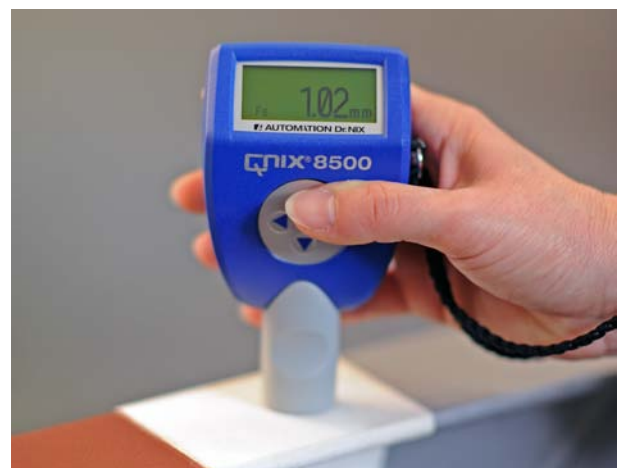
Abb. 15: Die zerstörungsfreie Messung der Trockenschichtdicke erfolgt mittels elektromagnetischer Messinstrumente.
