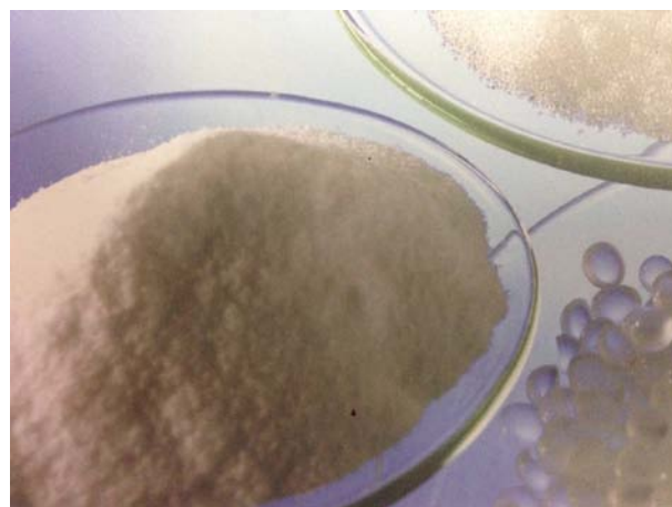
Abb. 5: Als Grundlage für Brandschutzbildner werden unter anderem gesundheitlich unbedenkliche Ammoniumpolyphosphate eingesetzt.
